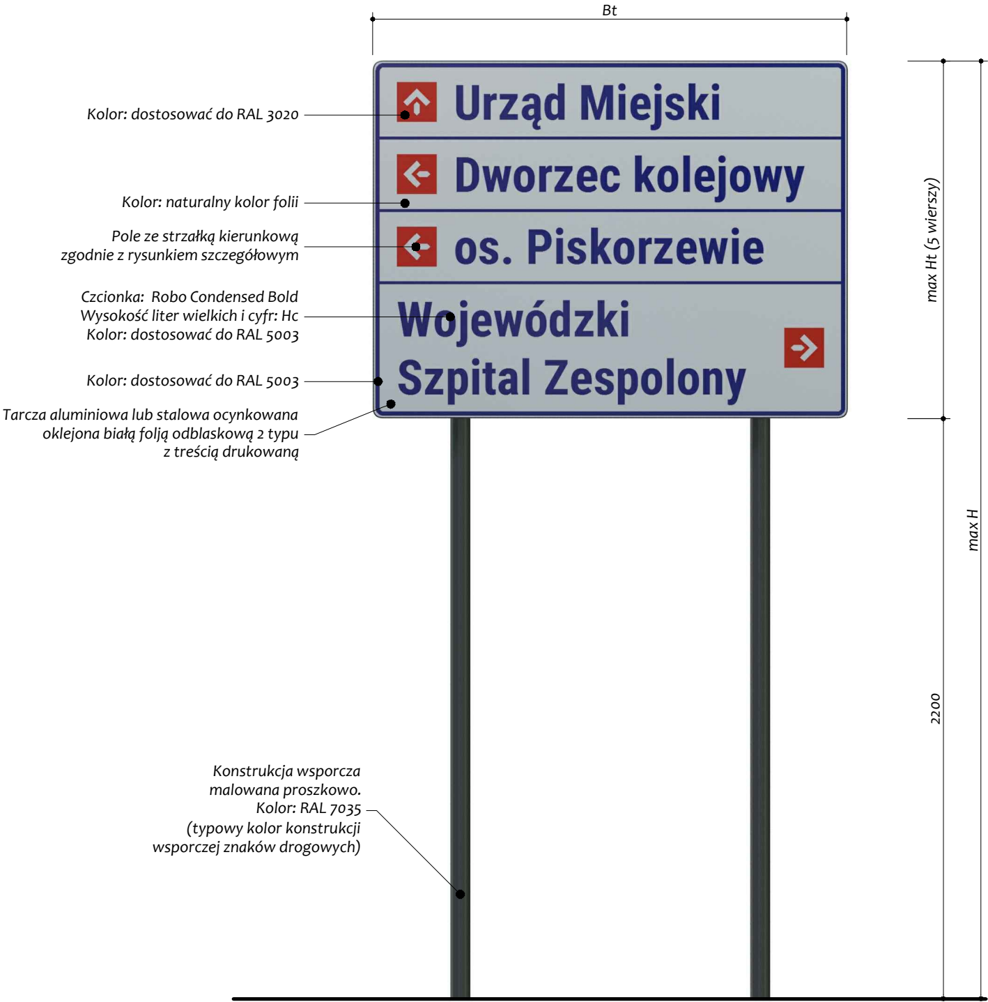
Rysunek architektoniczny tablic i konstrukcji wsporczej. Skala 1 : 20
