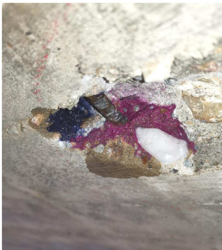
Fot. 1. Przeprowadzenie badania fenoloftaleiną w miejscu odkrywki pręta zbrojeniowego
