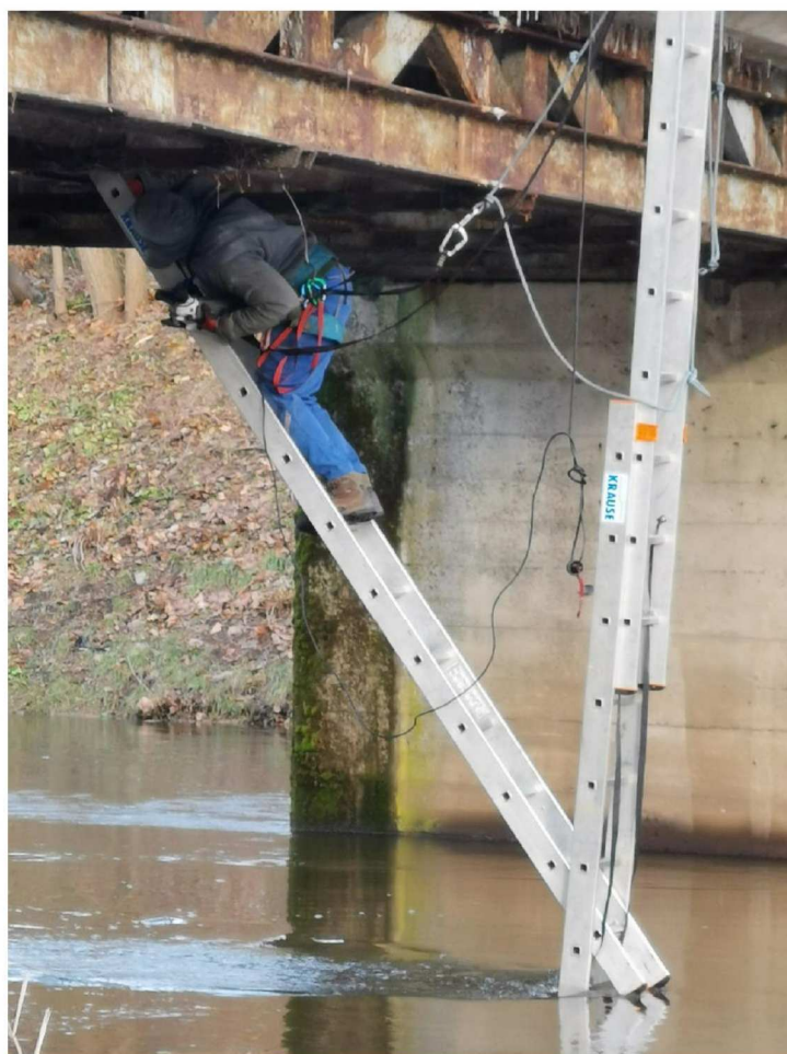
Ustawienie drabiny do pomiaru dźwigara środkowego
