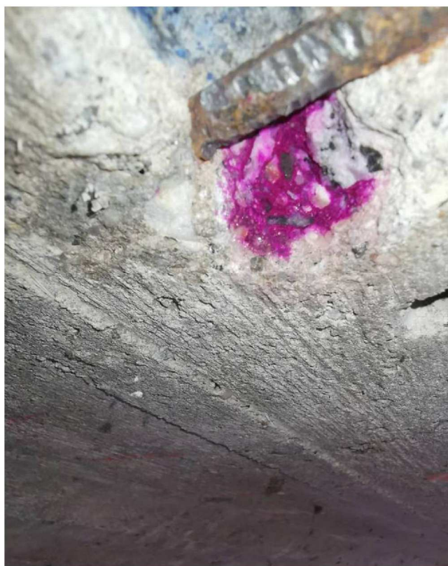
Fot. 1. Przeprowadzenie badania fenoloftaleiną w miejscu odkrywki pręta zbrojeniowego
