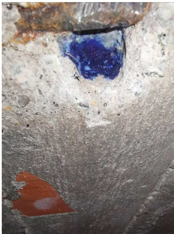
Fot. 2. Przeprowadzenie badania tymoftaleiną w miejscu odkrywki pręta zbrojeniowego
