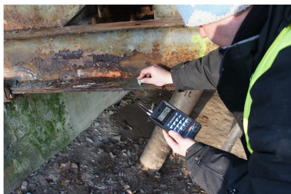
Rys. 20 Widok pomiaru pasa dolnego dźwigara skrajnego od strony górnej wody
