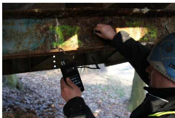
Rys. 21 Widok pomiaru środknika dźwigara środkowego
