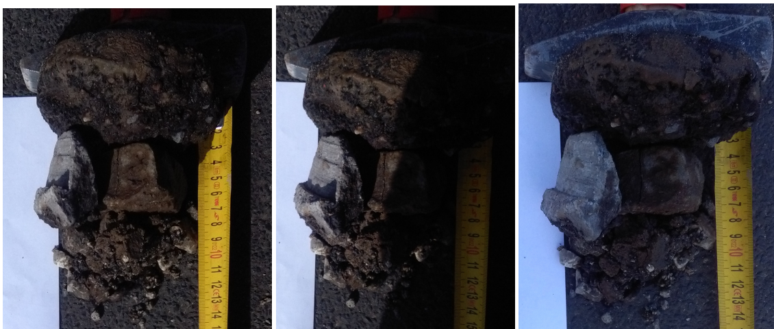
Rys. 2. Warstwa nawierzchni asfaltowej, rozpoznana w punkcie badawczym nr 5.
